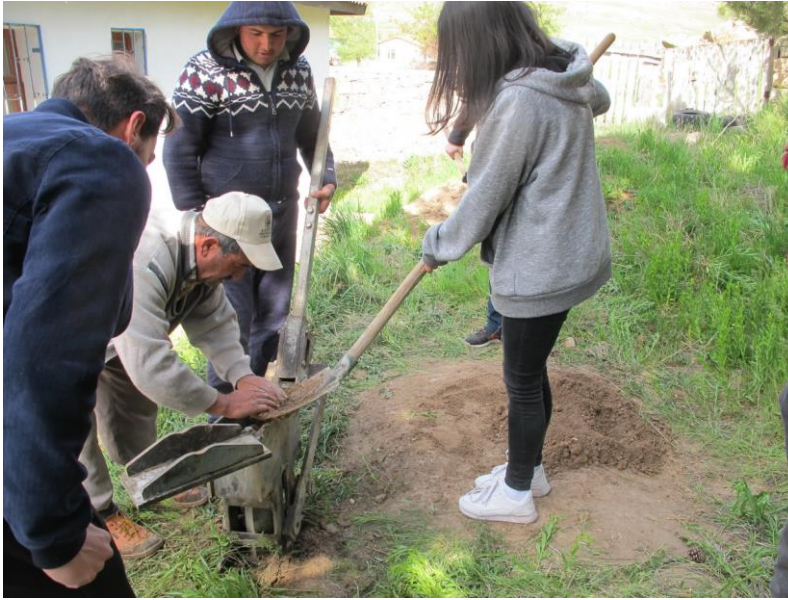
Şekil 13. Sıkıştırılmış tuğla makinesini toprak ile doldururken. (18kekc0210)
