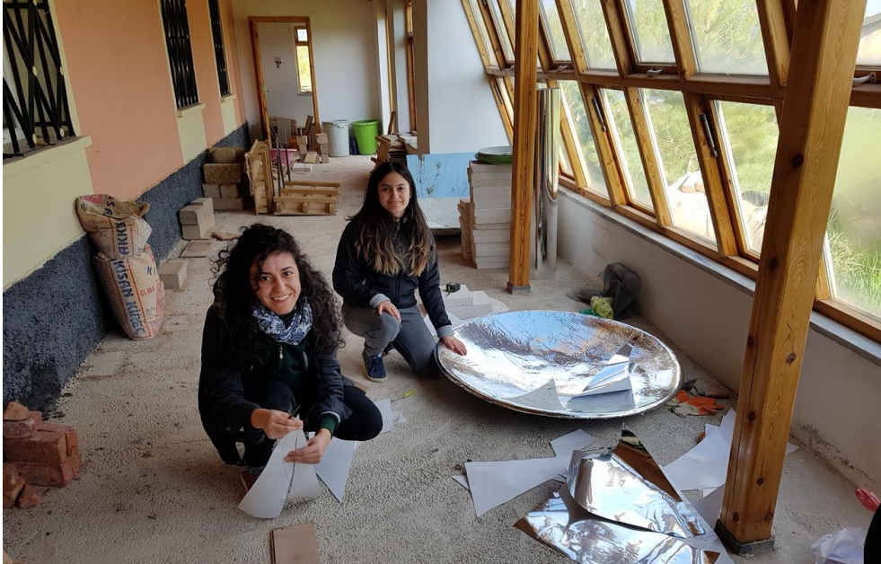
Şekil 18. Öğrenciler güneş ocağı toplayıcısını yeni bir yansıtıcı gümüş folyo ile kaplarken. (18kekc0229)
