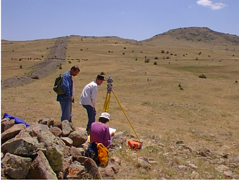
Şekil 5: Jeofiziksel yüzey araştırmasında kullanılan 20 metrelik gridin oluşturulmasında elektronik teodolit kullanılmaktadır. Güneydoğuya bakan resmin solunda şehir surlarının kuzeydoğu bölümü ile sağında Kale görülmektedir.
