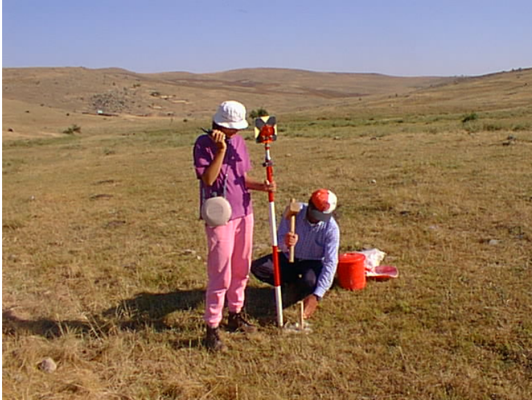
Şekil 6: Her 20 metrede bir zemine ahşap kazıklar çakılmaktadır. Kazıkların yeri beyaz kireçle işaretlenmekte, böylece çobanlar çay yapmak için kazıkları yaksalar bile yerleri kaybolmamaktadır. Teodoliti kullanan ve prizmayı taşıyan ekip üyeleri arasındaki iletişim el telsizleriyle sağlanmaktadır.
