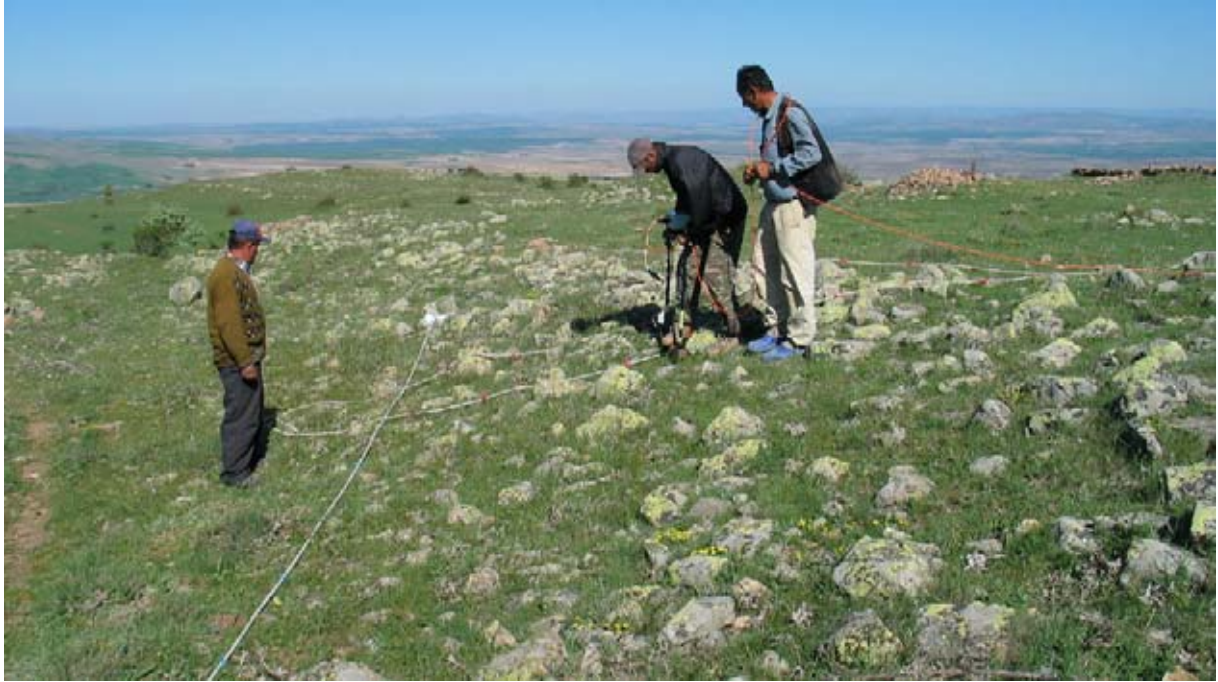
Şekil 19. Saray Yapı Grubunda direnç yöntemiyle yürütülen yüzey araştırması yüzeyin fazla taşlık olması nedeniyle yavaş ilerlemektedir.
