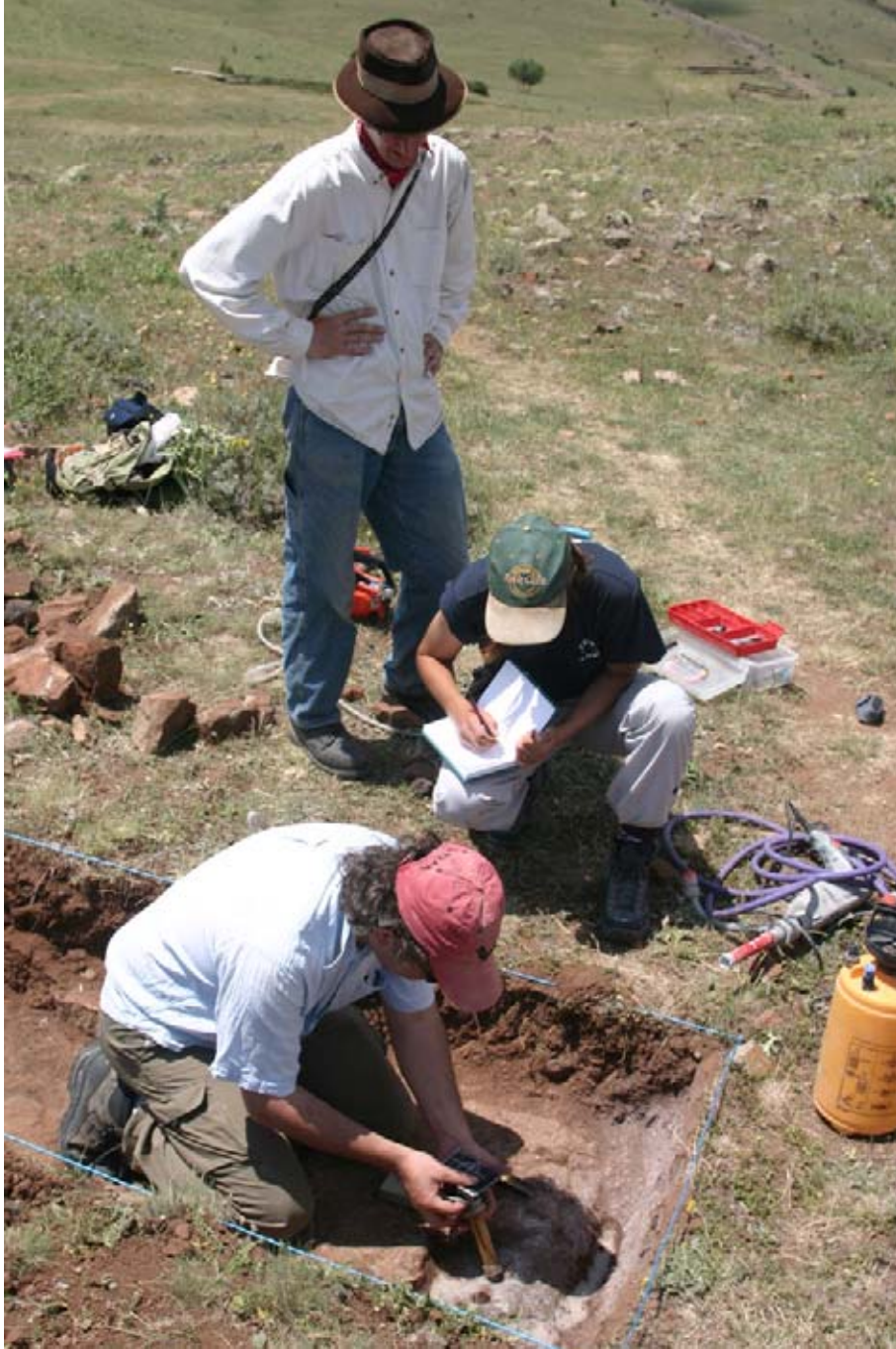
Şekil 44. Nurettin Kaymakçı, yangın sonucu başkalaşmış bir taştan alınan karot örneğin açısını ve yönünü ölçerken. (07dpnc1408)
