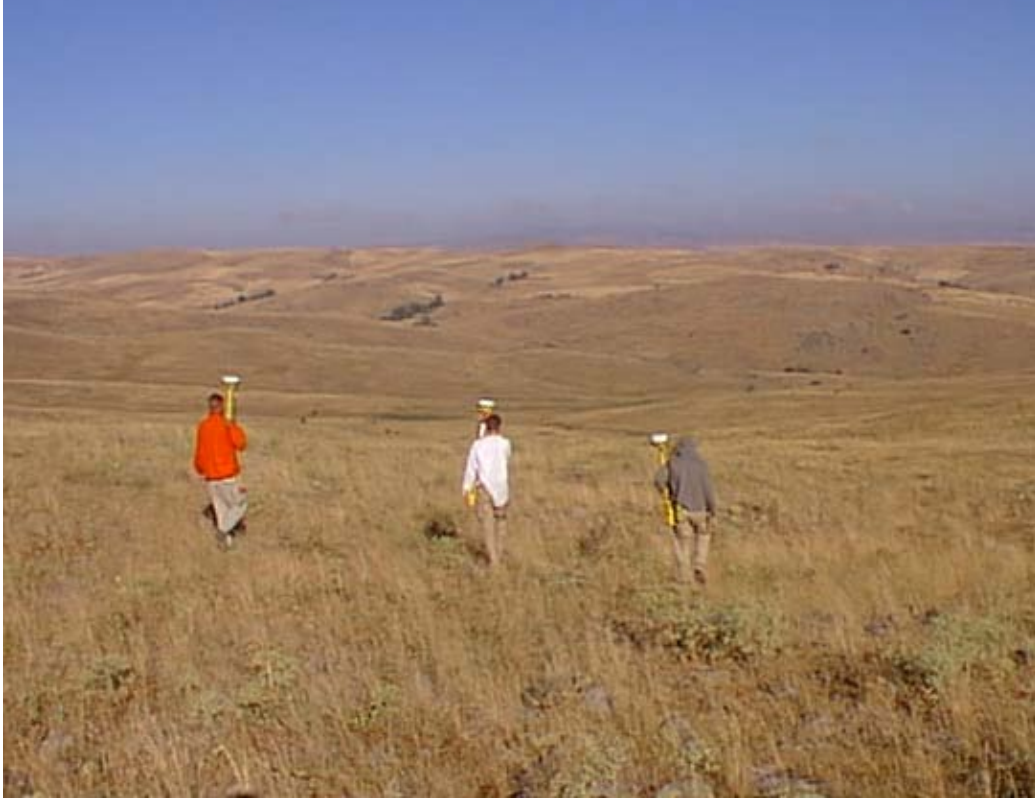
Şekil 4 Üç alıcıyla gerçekleştirilen kinetik GPS yüzey araştırması.
