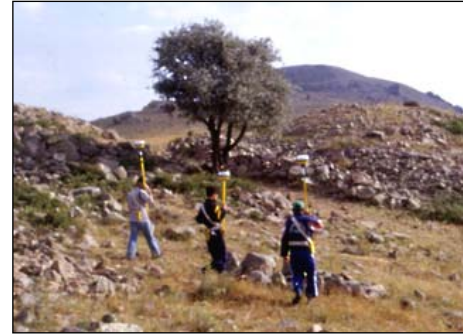
GPS aleti ile yüzey topografyasının haritalanması
