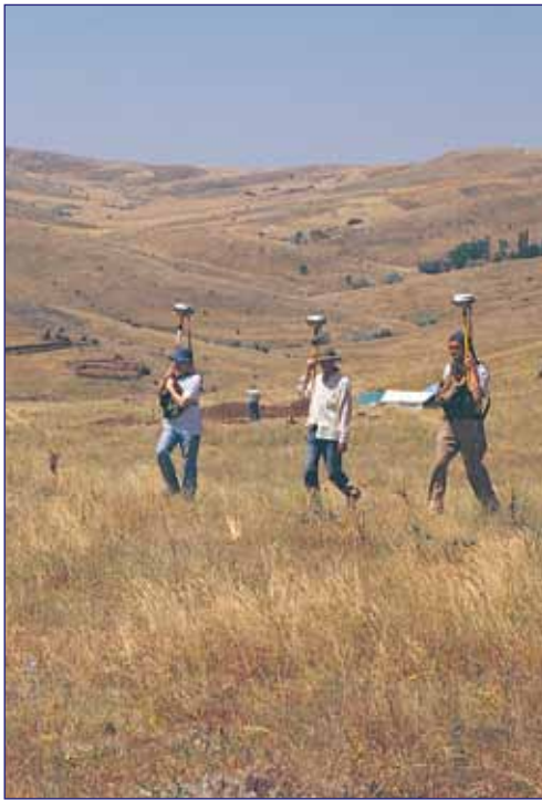
Figure 10: GPS kinetic survey with three receivers. Şekil 10: Üç adet alıcı kullanılarak yürütülen, GPS kinetik veri toplama çalışması.
