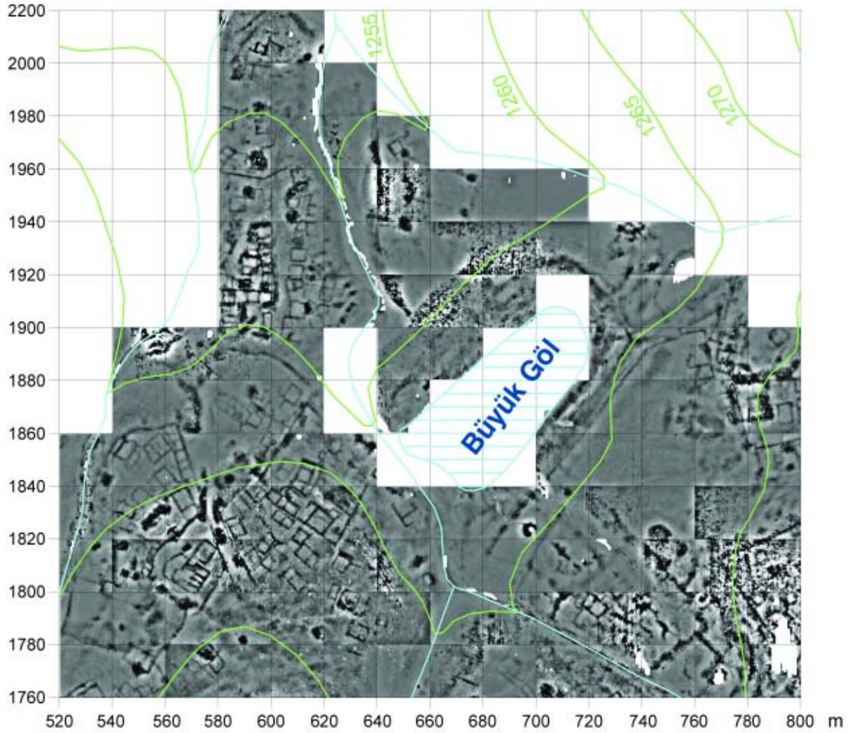
Figure 9. Map of the main portion of the 2004 Resistivity Survey. The blank area is the Büyük Göl and marshy streambed. Şekil 9. 2004 yılı elektrik direnç ölçme çalışmasının ana bölümü. Boş olan alanlar Büyük Göl ve bataklık dere yatağı.
