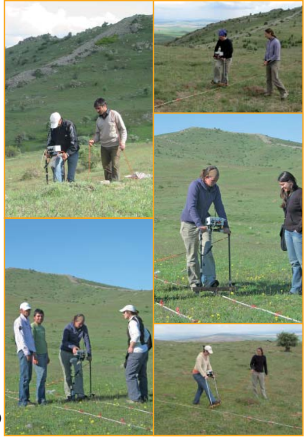
Figure 5. (a) Progress Map of the resistivity survey and transportation test trenches. (b) Resistivity survey in May 2008. Şekil 5. (a) Direnç yöntemiyle yüzeysel araştırması ile ulaşım araştırması deneme kazılarının ilerleyişini gösteren harita. (b) Mayıs 2008'de gerçekleştirilen direnç yöntemiyle yüzeysel araştırması.
